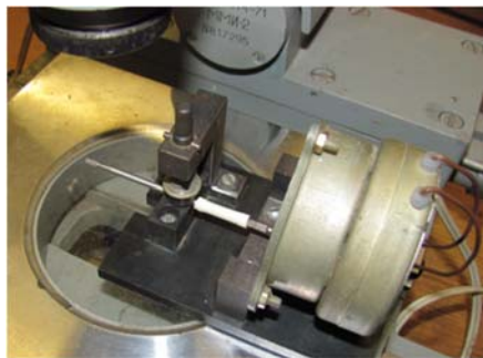
Рисунок 6 – Фотография устройства для измерения радиального биения боров и алмазных головок, установленного на столе микроскопа
