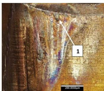
Рисунок 2 – Состояние реза после точения с подачей  $f = 0,2$  мм/об
