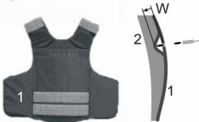
1 - многослойная тканевая преграда (бронежилет); 2 - регистрирующая среда; W - фактический прогиб. Рис. 1. Сертификационные испытания бронежилетов
