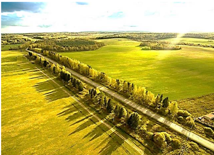
Рис. 8.7. Снегозадерживающие посадки вдоль дорог
