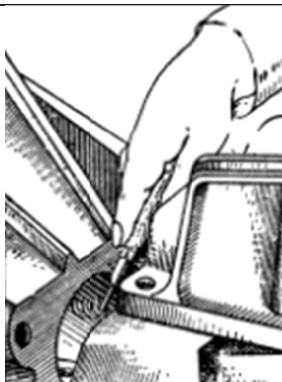
Рис. 3.6. Отсоединение оттяжной пружины муфты выключения сцепления
