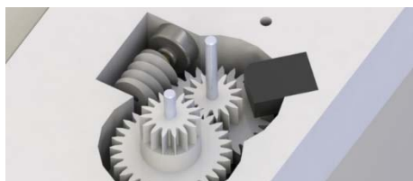
Рисунок 5 – Фотопрерыватель и фрагмент редуктора
