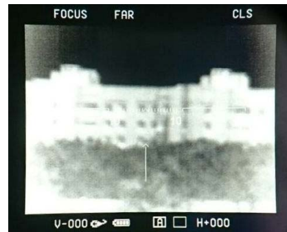
Рисунок 2 – Вид поля зрения и меню тепловизионного прицела ТП-1
