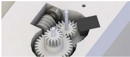
Рисунок 5 – Фотопрерыватель и фрагмент редуктора
