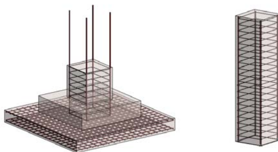
Рисунок 1 – Модели монолитных фундамента и колонны с армированием
