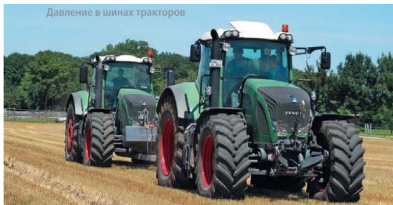
Рисунок 3 – Трактор фирмы Fendt на полевых испытаниях по регулированию давления воздуха в шинах
