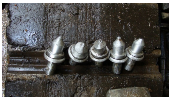
Рисунок 3 – Опытные образцы после дорожных испытаний
