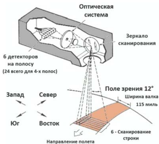
Рисунок 3 – Схема мультиспектрального последовательного сканирования
