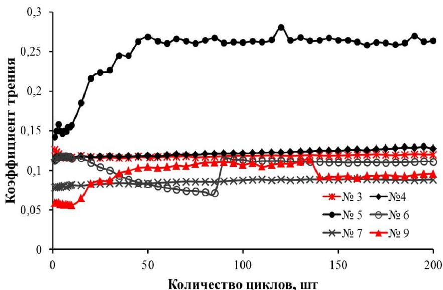
Рисунок 1 – График зависимости коэффициентов трения от числа циклов
