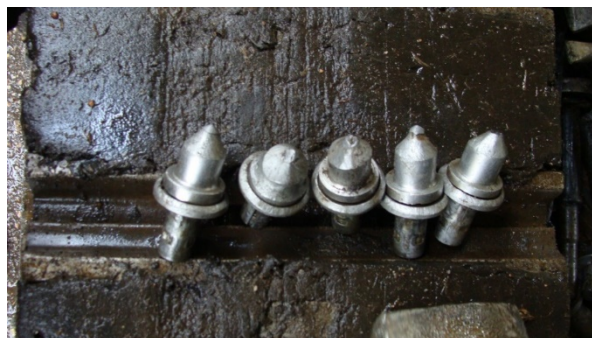
Рисунок 3 – Опытные образцы после дорожных испытаний
