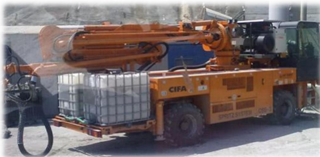
Рисунок 6 – самоходная машина для нанесения набрызг-бетона
