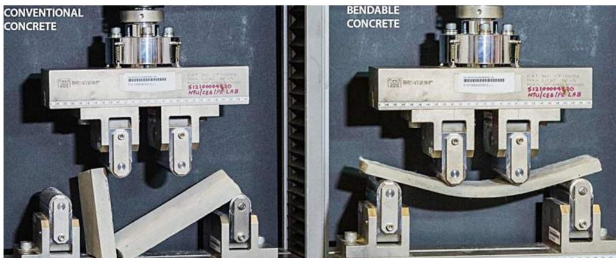
Рисунок 1 – Испытание образцов из обычного и из эластичного бетона
