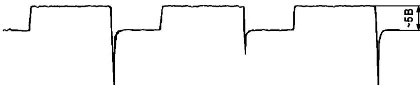
Рис. 4.15. Осциллограмма переменного напряжения клапана рециркуляции отработавших газов
