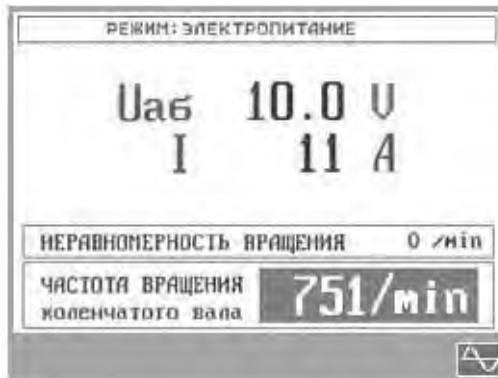
Рис. 3.3. Окно сообщения результатов измерения в системе электропитания:  $U_{аб}$  – напряжение на клеммах аккумуляторной батареи;  $I$  – постоянный электрический ток, потребляемый или отдаваемый аккумулятором или другими потребителями
