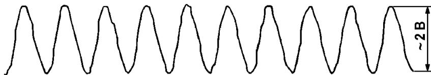
Рис. 4.12. Осциллограмма переменного напряжения дозатора топлива.
