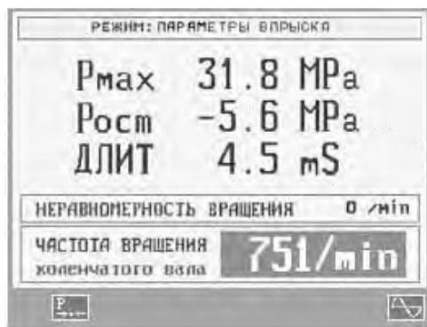
Рис. 3.6. Окно сообщения результатов измерения параметров впрыска топлива: P<sub>max</sub> – максимальное давление впрыска топлива; Рост – остаточное давление в топливопроводе высокого давления; ДЛИТ – длительность подачи топлива
