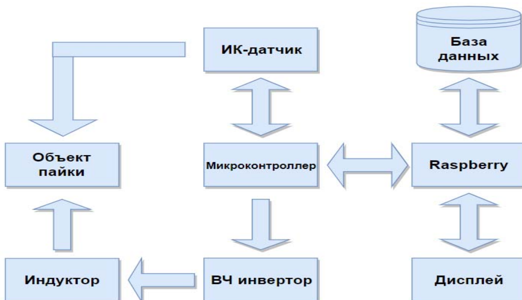
Рисунок 3 – Схема установки контроля параметров индукционной пайки
