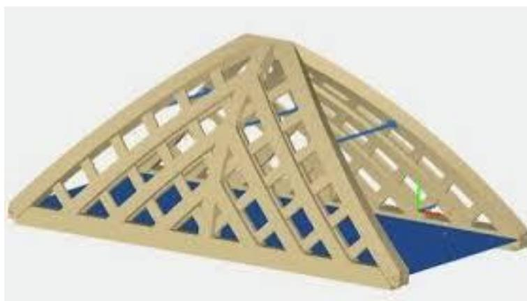
Рисунок 1 – 3D модель коробчато-балочной конструкции пролетного строения
