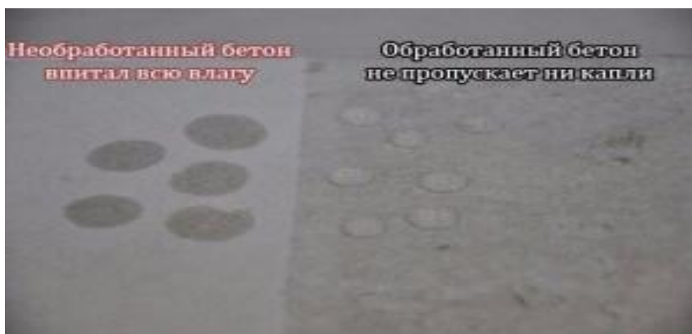
Рисунок 2 – Сравнение обработанной поверхности бетона гидрофобизатором с необработанной поверхностью
