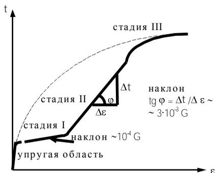
Рис. 11. Кривая напряжение–деформация для монокристаллов с ГЦК решеткой
