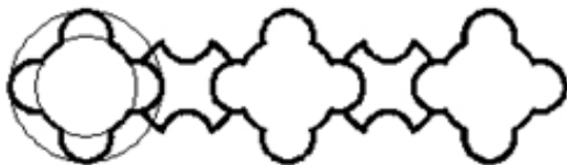
Рисунок 2 – Профили, полученные последовательной обкаткой симметрично-кругового профиля
