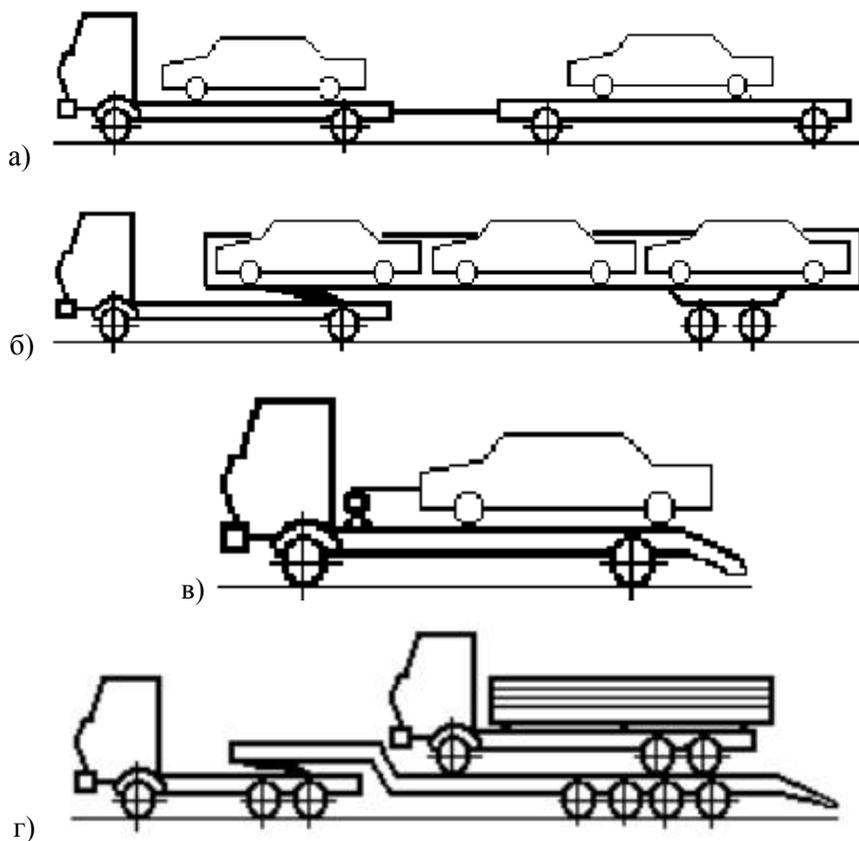
Рис.1.3. Основные способы эвакуации методом полной погрузки:
