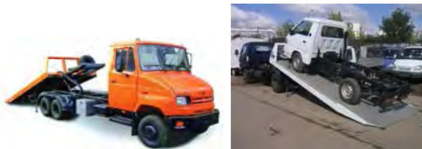
Рис. 1.11. Эвакуаторы со сдвижной платформой
