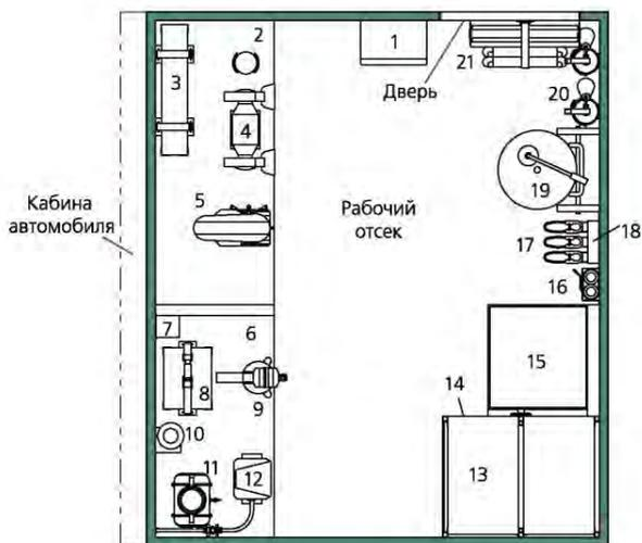
Рис. 3.28. Расположение основного оборудования в кузове-фургоне в РЭМ-КС:
