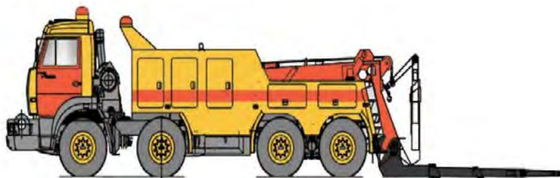
Рис. 3.8. Эвакуатор автомобилей и автобусов на шасси КАМАЗ-6540
