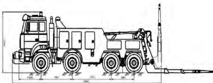
Рис. 3.11. Эвакуатор автомобилей и автобусов на шасси Урал-6563-1010-01
