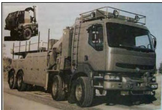
Рис. 3.46. Ремонтно-эвакуационный автомобиль Renault Kerax 400.32 8x8.2
