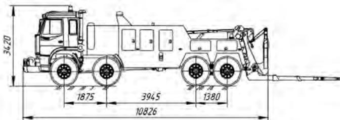
Рис. 3.48. Эвакуатор автомобилей и автобусов на шасси ИВЕКО-41840369
