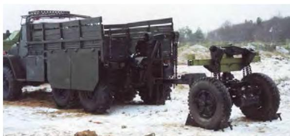
Рис. 1.8. Буксирный прицеп, обеспечивающий погрузку неисправного автомобиля за счёт возможности складывания дышла прицепа в вертикальной плоскости силой тяги автомобиля – тягача
