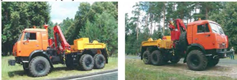
Рис. 3.15. Машины технической помощи МТП-А2.2-000 и МТП-А2.2-001
