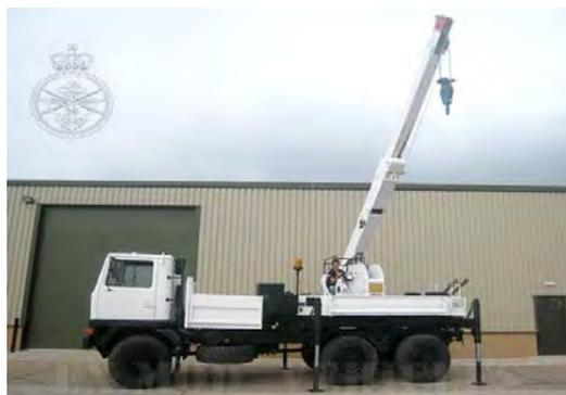
Рис. 3.34. Эвакуатор с КМУ Atlas AK 4006 на шасси Bedford TM
