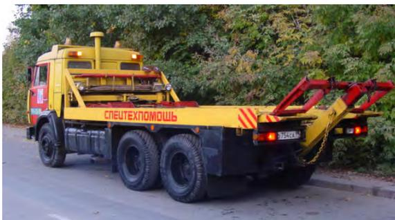
Рис. 3.5. Спец. техпомощь Камаз-532150
