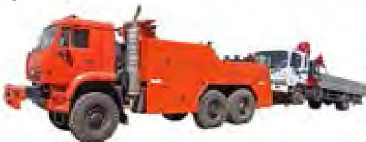
Рисунок 1.14. Эвакуатор с частичной погрузкой
