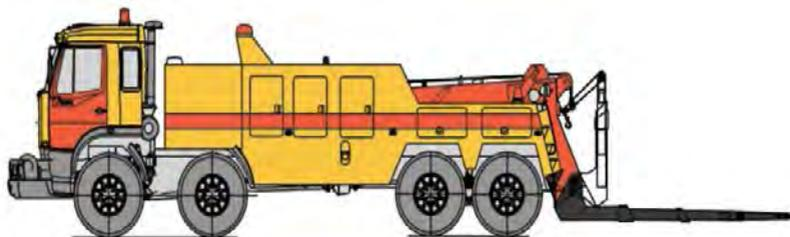
Рис. 3.47. Эвакуатор автомобилей и автобусов на шасси ИВЕКО 41840369
