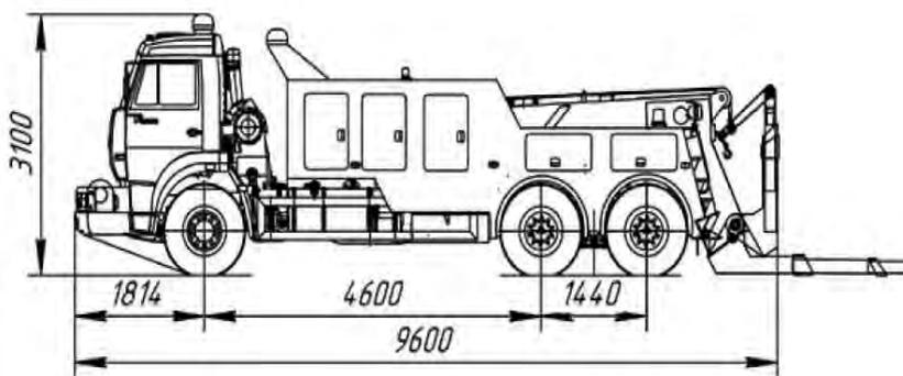
Рис. 3.7. Эвакуатор автомобилей и автобусов на шасси КАМАЗ-6520
