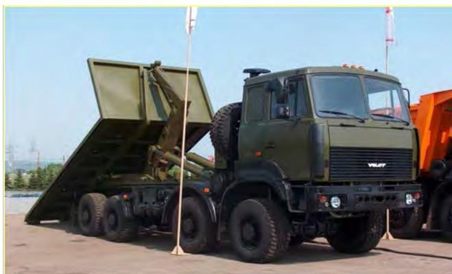
Рис. 4.6. Тягач МЗКТ-73011, оборудованный системой мультилифт МПР-2
