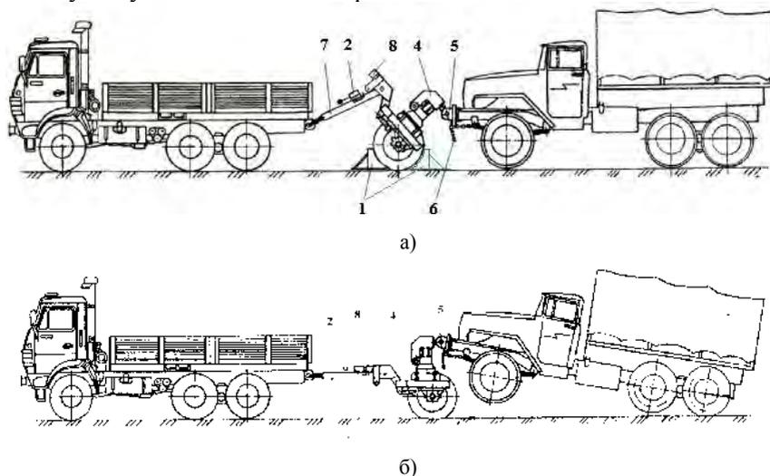
Рис. 1.9. Принцип действия буксирного прицепа со складыванием дышла:
