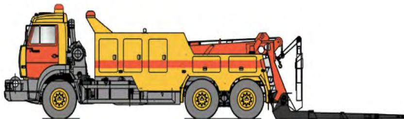
Рис. 3.6. Эвакуатор автомобилей и автобусов на шасси КАМАЗ-6520
