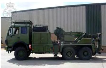
Рисунок 3.36. Эвакуаторы Mercedes 2628
