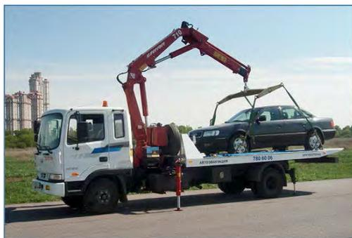
Рис. 3.32. Эвакуатор на базе автомобиля «HYUNDAI HD-120 Extra Long
