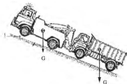
Рис. 1.6. Отрыв передней оси эвакуатора от дороги
