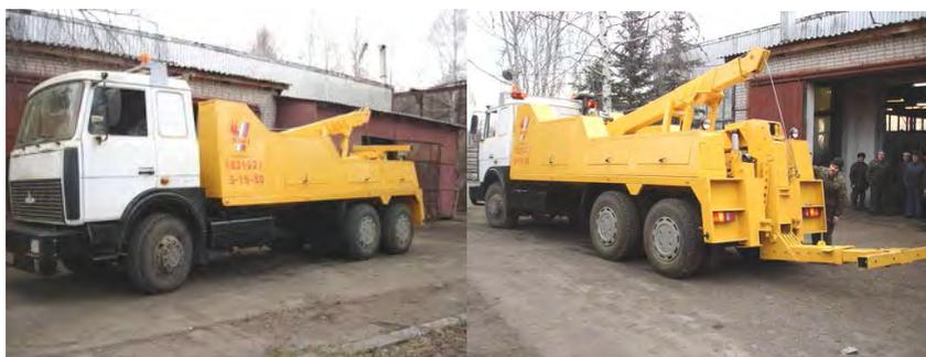
Рис. 4.7. Эвакуатор на базе автомобиля МАЗ-630305-250
