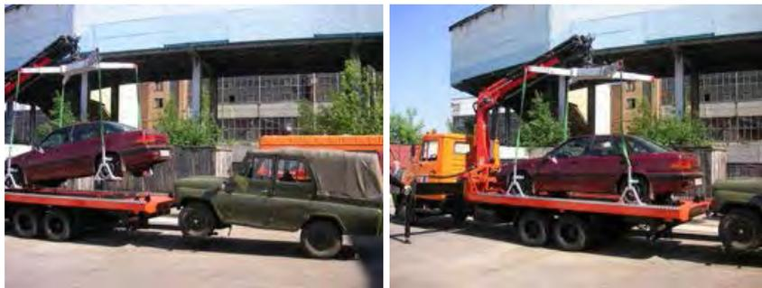
Рис. 1.16. Эвакуатор, способный эвакуировать два автомобиля одновременно
