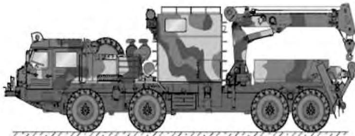
Рис. 3.26. Машина ремонтно-эвакуационная колесная средняя РЭМ-КС
