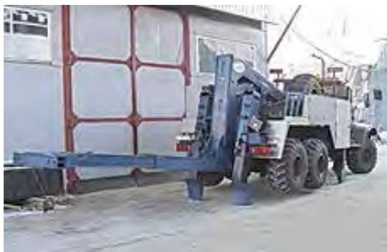
Рис. 3.12. Эвакуатор на базе автомобиля КрАЗ-6322-076
