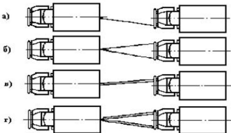
Рис. 1.2. Схемы установки буксирных приспособлений:
