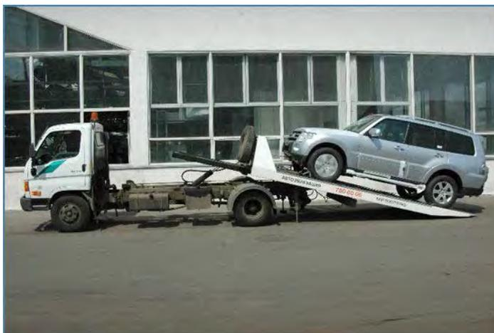
Рис. 3.31. Эвакуаторы с подъемно-сдвижной платформой на базе автомобилей: «HYUNDAI HD-72», «HYUNDAI HD-78»
