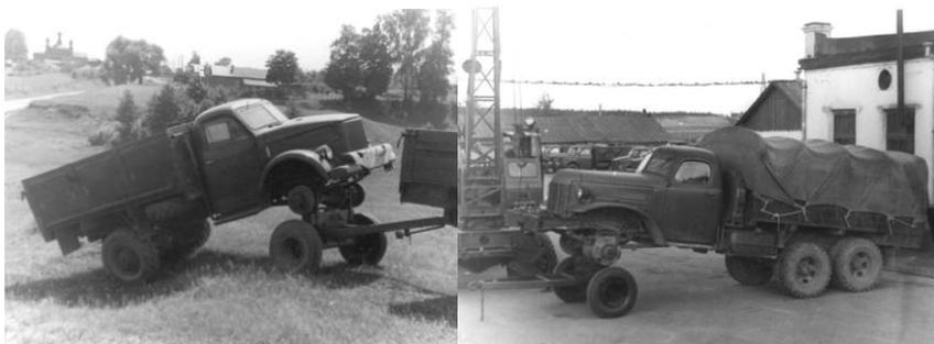
Рис. 1.7. Способ эвакуации неисправного автомобиля частичной погрузкой на подкатную тележку
