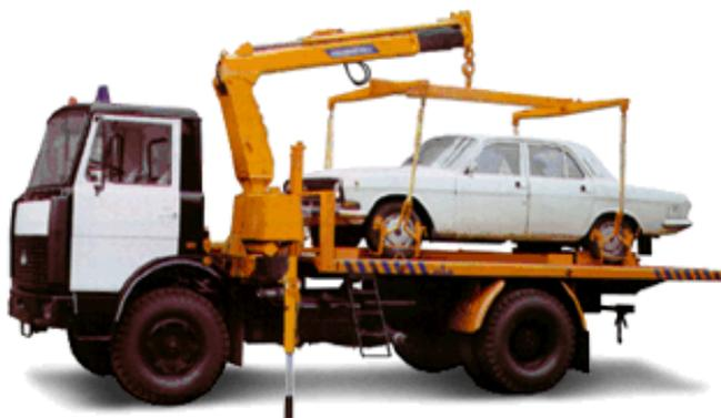
Рис. 4.2. Эвакуатор на базе автомобиля МАЗ-53371-100
