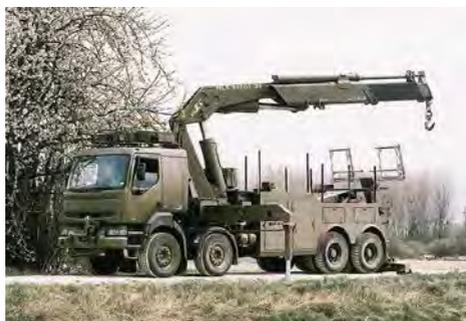
Рис. 3.45. Ремонтно-эвакуационный автомобиль Renault Kerax 385.40 8x4.2
