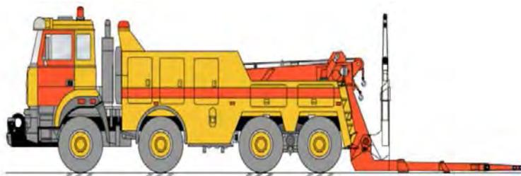
Рис. 3.10. Эвакуатор автомобилей и автобусов на шасси Урал-6563-1010-01
