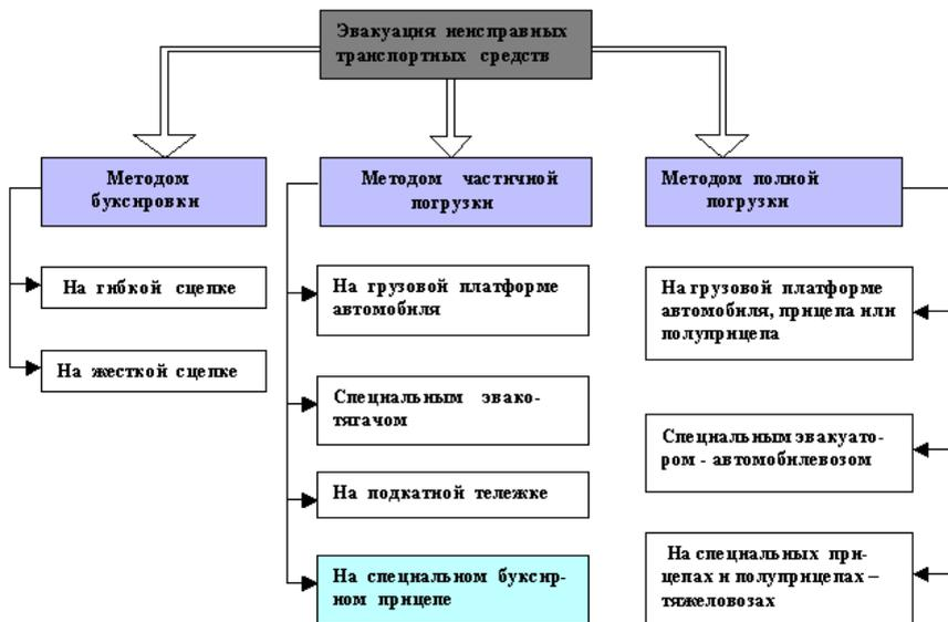
Рис. 1.1. Основные способы эвакуации неисправных транспортных средств
