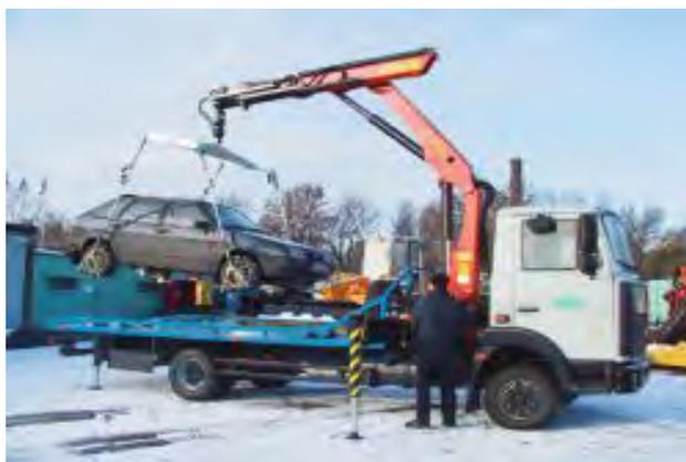
Рис. 4.3. Эвакуатор на базе автомобиля МАЗ – 437043
