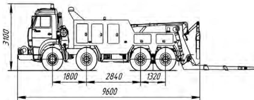
Рис. 3.9. Эвакуатор автомобилей и автобусов на шасси КАМАЗ-6540
