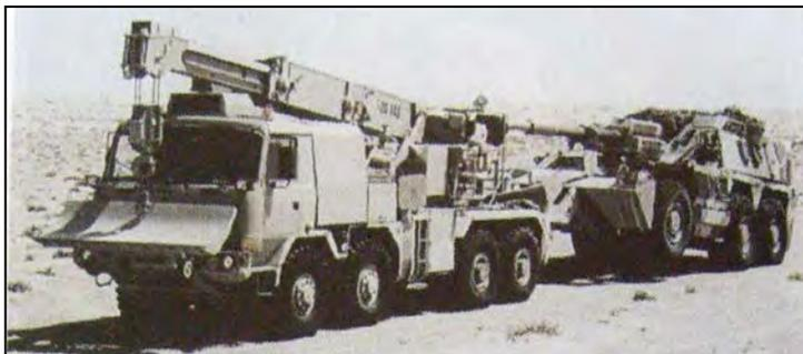
Рис. 3.43. Тяжелый ремонтно-эвакуационный тягач Tatra T816-6ZVP8T44 400 8x8.1R
