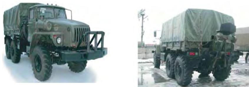
Рис. 3.1. Легкий колесный эвакуационный транспортер КТ-ЛМ
