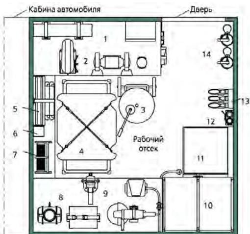
Рис. 3.25. Расположение основного оборудования в кузове-фургоне в РЭМ-К:
