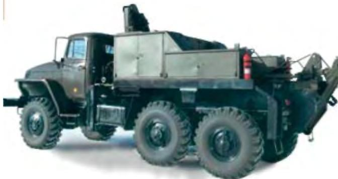
Рис. 3.18. Машина технической помощи МТП-А2М.1
