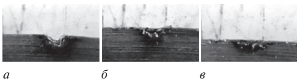
Рисунок 4 — Изображения поверхности диска при различной окружной скорости его вращения v_d в процессе ЭЭО: a - v_d = 0 ; b - v_d = 215 м/мин; c - v_d = 450 м/мин
