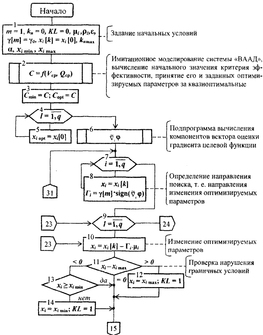
Рисунок 9.2 – Схема алгоритма оптимизации методом стохастической аппроксимации с ускоренной сходимостью (начало, окончание см. на с. 101)
