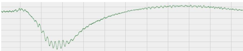
Рис. 1 – Виброграмма пролётного строения эксплуатируемого моста. Получена с использованием тензометрии
