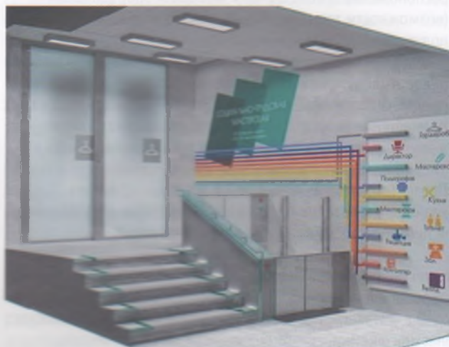
Рис. 2. Социально-трудовые мастерские. Входная зона с обеспечением подъема на уровень этажа и информационной доступности (фрагмент проекта студентки Е. Челиковой)
