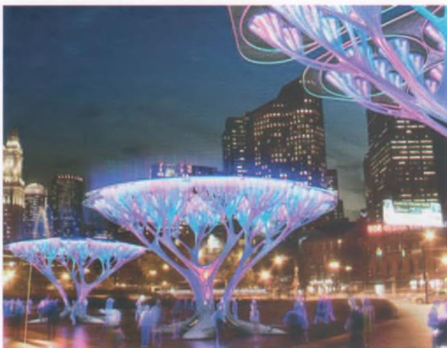
Рис. 15. Искусственные деревья, оборудованные солнечными панелями, воздушными фильтрами, а также качелями, работающими как генераторы; вечером включается LED-подсветка
