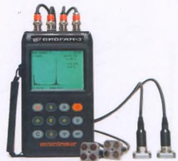
**Рисунок 10 – Виброанализатор портативный «Вибран-3»**
