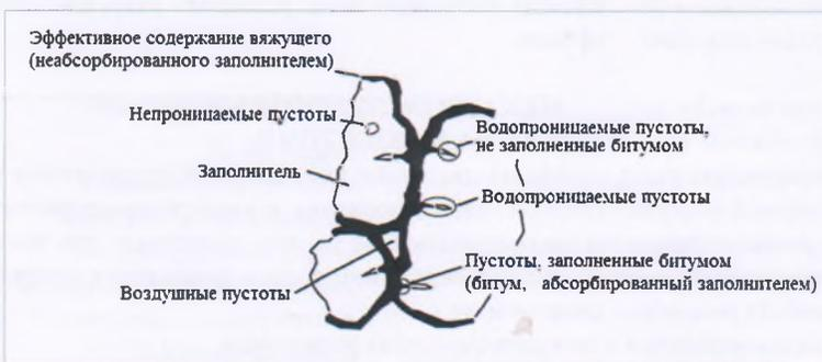
**Рисунок 1 – Типичное изображение наполнителя, битума и воздушных пустот в асфальтобетонной смеси под микроскопом**
