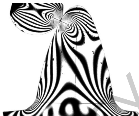
Рисунок 2 – Интерференционная картина распределения напряжений на модели
