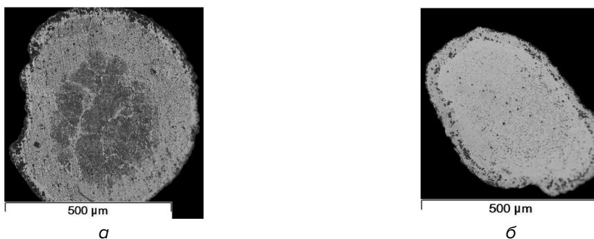
Рис. 6. ДЛ сплавы для индукционной наплавки после оплавления: а – ДЛ сплав после оплавления с 100 А; б – ДЛ сплав после оплавления с 150 А
