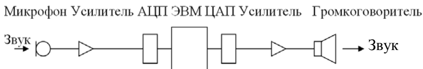
Рис. 18. Схема звукового тракта акустической подсистемы
