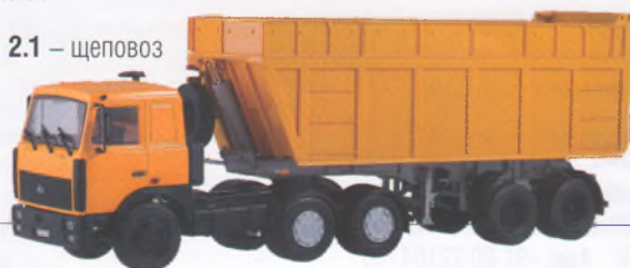
Рис. 2. Щеповоз и топливовоз со съемным контейнером
