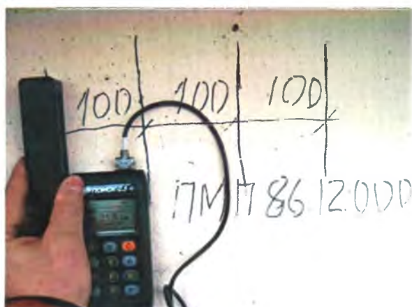
Рисунок 2 – Определение положения арматуры прибором «Поиск 2,5»
