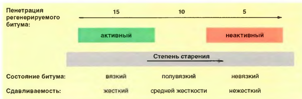
Рисунок 2 – Градуированная шкала величины пенетрации регенерируемого битума
