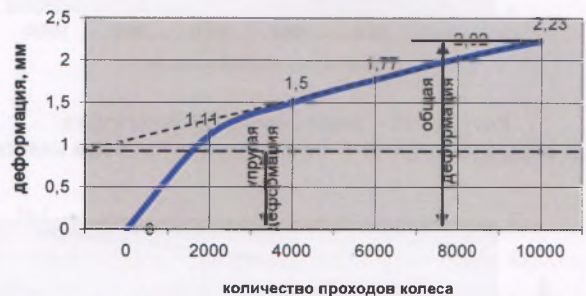
Рисунок 16 – Зависимость глубины колеи в асфальтобетоне 1-А от количества проходов колеса
