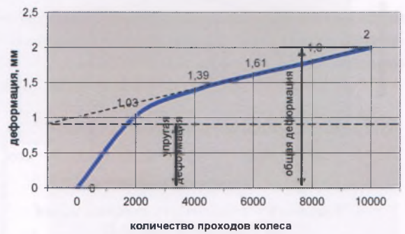
Рисунок 6 – Зависимость глубины колес в асфальтобетоне 3-А от количества проходов колеса
