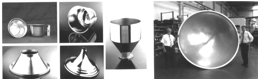
Рис. 33. Примеры деталей, изготавливаемых на станках для ротационной вытяжки с программным управлением
