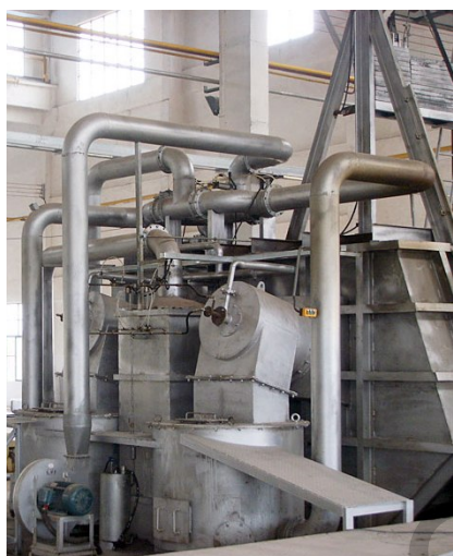
Рис. 2. Регенеративная горелка фирмы BLOOM[10]: а – установка горелки на термической печи; б – принципиальная схема регенеративной горелки
