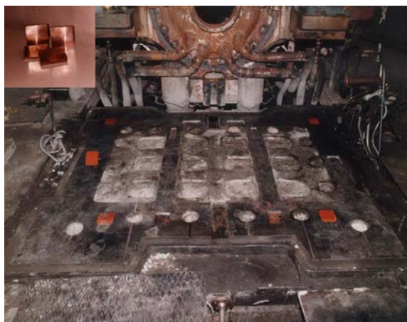
Рис. 1. Фундаментная рама с установленными плитками из композиционных материалов с макрогетерогенной структурой и плитки перед установкой (верхний левый угол)
