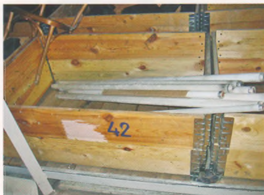
Ошибка. Лампы собираются навалом в деревянный ящик
