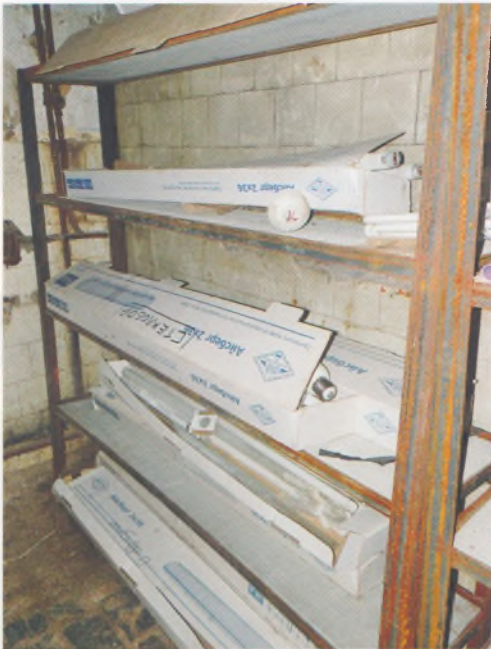
Ошибка. Лампы не разделяются по видам, бой ламп не демеркурируется. Деревянные стеллажи не покрыты ртутьнепроницаемым составом
