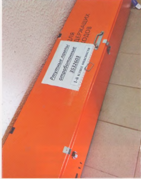
Контейнер изготовлен с соблюдением требований СТБ 2168-2011, приведена корректная маркировка
