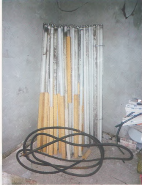
Ошибка. Лампы собираются и хранятся небезопасным способом, отсутствует ящик (контейнер)
