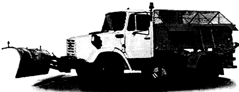
Рис. 2. Машина для распределения противогололедных материалов
