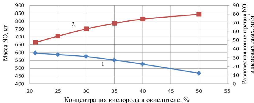
Рис. 1. Зависимость концентрации  $\text{NO}$  и объема его выбросов при сжигании  $1 \text{ м}^3$  природного газа от концентрации кислорода в исходной смеси «воздух – кислород»:
