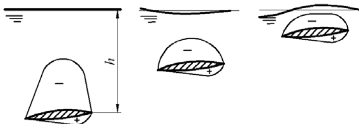
Рис. 2.8. Влияние свободной поверхности воды на подъемную силу крыла
