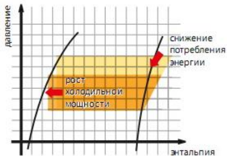
Рисунок 2. Оптимизация холодильного цикла за счет применения электронного TRV
