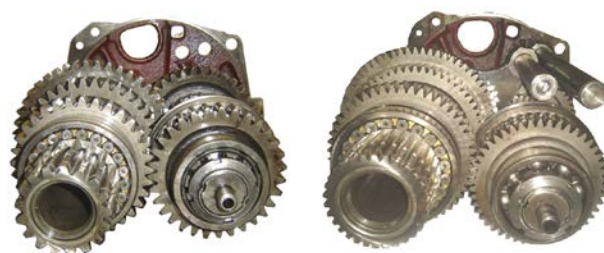
Рис. 7. Фрагменты узла передач серийной ( \epsilon_\alpha < 2 ) и опытной ( \epsilon_\alpha > 2 ) коробок передач
