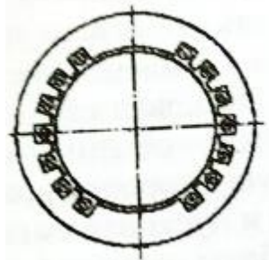
Рисунок 1.84 - Статор однофазного синхронного электродвигателя
