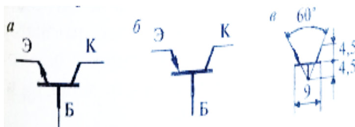
Рисунок 2.15 - Условное графическое обозначение в электронный схемах транзистора и размеры транзистора
