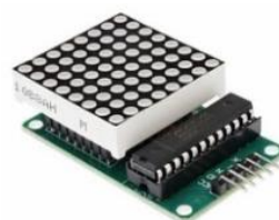
Рисунок 2.81 - Матричные светодиодные индикаторы
