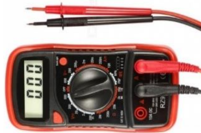
Рисунок 1.28 - Портативный цифровой мультиметр
