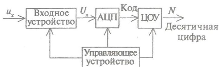
Рисунок 1.23 - Упрощенная структурная схема цифрового вольтметра.
