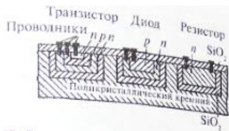
Рисунок 2.88 - Структура части полупроводниковой ИМС
