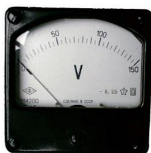
Рисунок 1.21 - Вольтметр магнитоэлектрической системы
