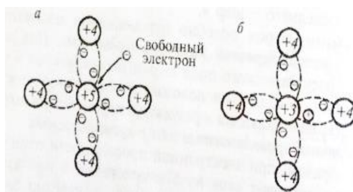
Рисунок 2.3 - Схема связи пяти-(а) и трехвалентной (б) примеси с германием
