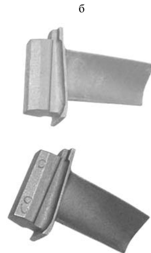
Рис. 2. Схема установки для избирательного спекания порошков (а) и образцы изделий (б)
