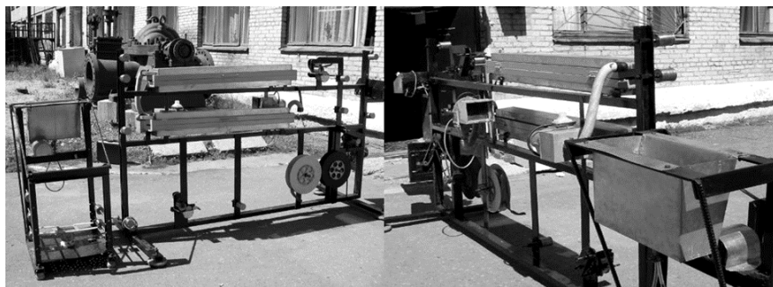
Рисунок 14. – Опытно-промышленная установка УЛШ-60 для производства ленточного шлифовального инструмента методом электростатического нанесения рабочих слоев из ориентированных зерен электрокорунда
