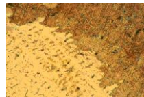
Рисунок 2. – Структура поверхности покрытий из БрОФ 10-1 без добавок (а), с добавкой 2 масс.% \gamma -Al(OH) 3 (б), с добавкой 4 масс.% \gamma -Al(OH) 3 (в)
