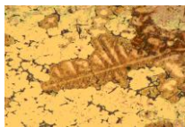
Рисунок 2. – Структура поверхности покрытий из БрОФ 10-1 без добавок (а), с добавкой 2 масс.% \gamma -Al(OH) 3 (б), с добавкой 4 масс.% \gamma -Al(OH) 3 (в)
