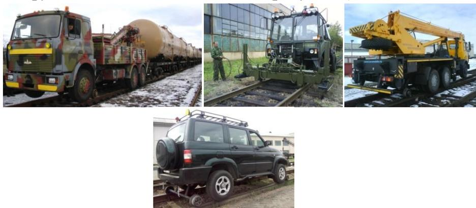
Рисунок 1 – Многофункциональные транспортные средства на комбинированном ходу разработки УО «БелГУТ»
