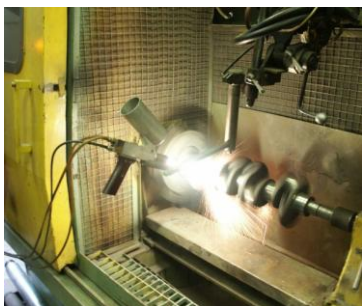
Рис. 1. Процесс газопламенного напыления
