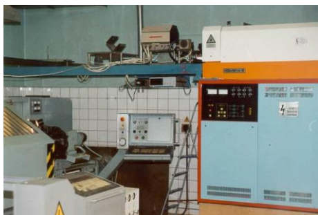
Рис. 3 Установка для лазерного термоупрочнения
