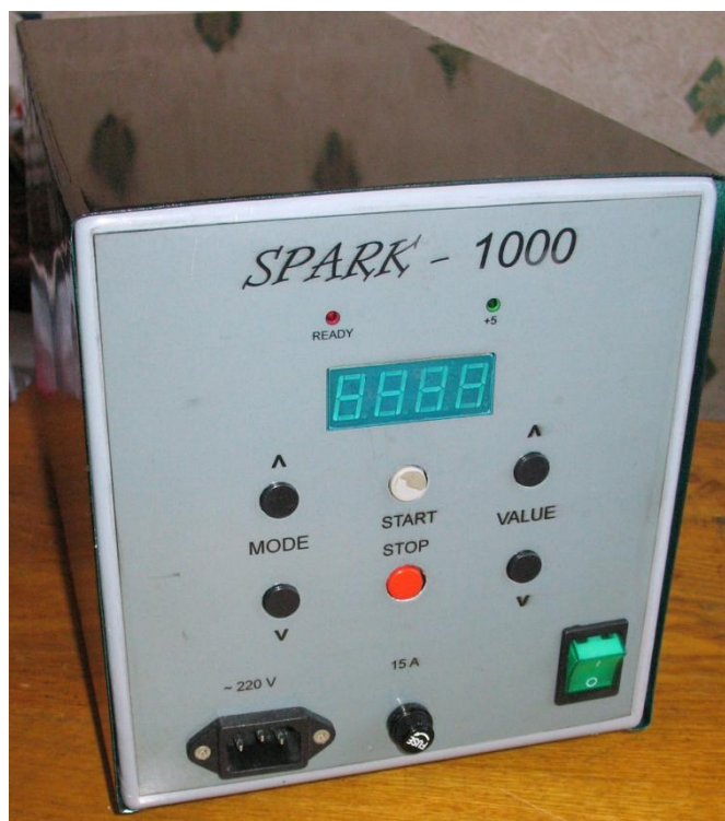
Рисунок 3 – Внешний вид установки для ЭИЛ SPARK-1000
