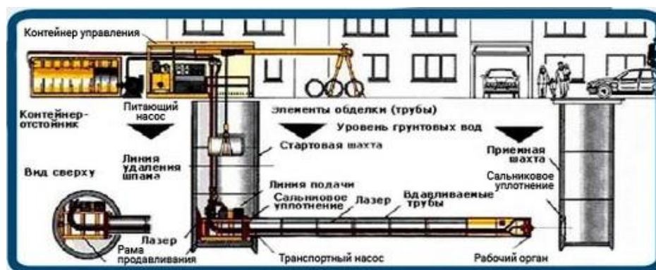
Рисунок 1 – Принципиальная схема микротоннелирования
