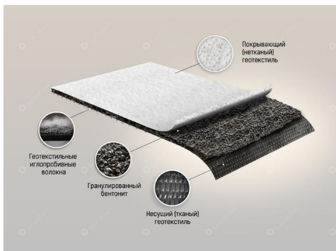
Рисунок 1 – Структура бентонитового мата
