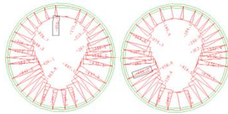
Рисунок 7 – Эпюра продольных усилий, возникающая в конструкции железобетонной обделки на стадии завершения строительства тоннеля
