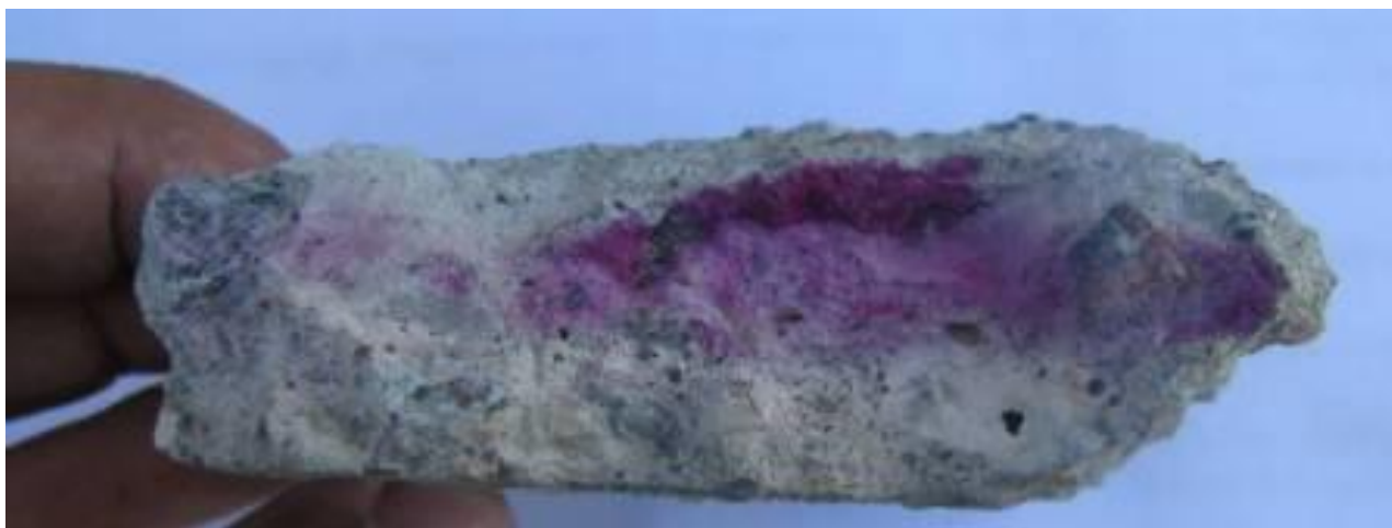
Рисунок 1 – Свежесколотый бетон, обработанный фенолфталеином
