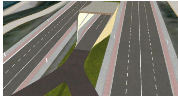
Рисунок 5.2 – Архитектурно-планировочное решение въезда/выезда в тоннель
